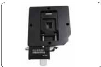
■ QE-F6-D样品台适用于背电极样品电池，对于单片多块电池的样品，采用手动旋转轮选择要测量的电池。样品台可以根据样品尺寸、电极位置定制。标准配备圆头探针，尖头或者锯齿形探针可选，且探针具有伸缩性，保证与样品接触良好。适用于钙钛矿电池、有机电池等。
