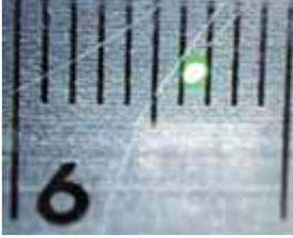
1mm 圆形光斑，全部照射在感光面内，测量更加准确
