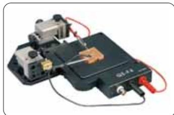
■ QE-F4样品台适用于正面电极、正反异面电极电池的QE测量，探针臂可三维移动，探针圆润，可用于薄膜电池。
