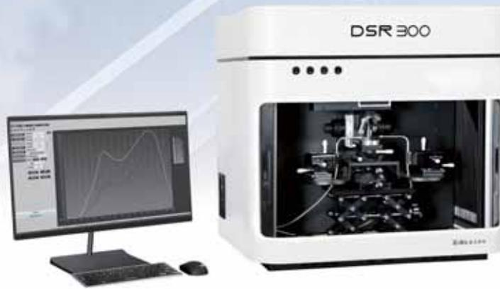
DSR300 系列微纳器件光谱响应度测试系统是一款专用于低维材料光电测试的系统。其功能全面，提供多种重要参数测试。系统集成高精度光谱扫描，光电流扫描以及光响应速率测试。40 $\mu$ m 探测光斑，实现百微米级探测器的绝对光谱响应度测量。超高稳定性光源支持长时间的连续测试，丰富的光源选择以及多层光学光路设计可扩展多路光源，例如超连续白光激光器，皮秒脉冲激光器，半导体激光器，卤素灯，氙灯等，满足不同探测器测试功能的要求。是微纳器件研究的优选。
