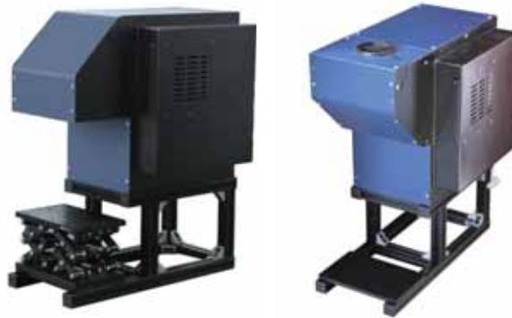
太阳模拟器可以用来模拟实验、生产所需的真实太阳光辐照条件, 可实现全天候不间断的光辐照条件, 使实验、生产不受测试条件与环境的约束, 因而其在光伏器件的研究和质检中被广泛的应用。
