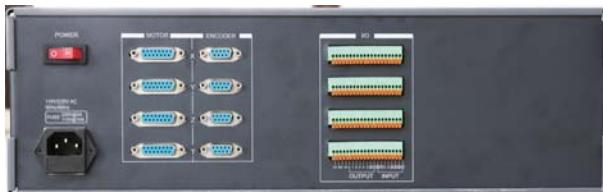
此为TMC-USB-1、2、3、4-ASP1, TMC-USB-1、2、3、4-ASP2控制箱后面板。
