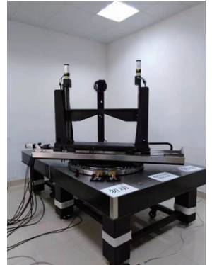
仪器支架 隔振光学平台
